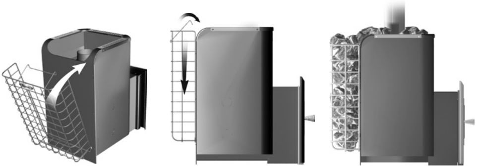
Рисунок -8. Установка сетки-каменки на печь.
