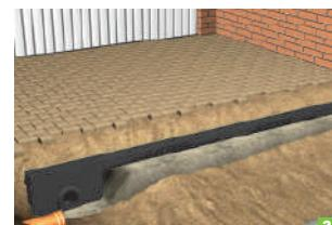
3) Монтаж начинается с установки пескоуловителя. Лотки устанавливаются в либо по принципу шпунт-паз.
