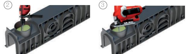
4. При невозможности осуществлять замкнутый пропил, необходимо сделать запилы по контуру в доступных местах, а затем выбить заглушку молотком. Для увеличения жесткости при выбивании заглушки обязательно устанавливать и закреплять решетку до начала выбивания.
