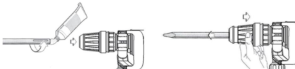
Для установки оснастки в патрон переместите фиксирующую втулку в сторону корпуса перфоратора и удерживайте её в таком положении. Вставьте оснастку в ударный патрон слегка проворачивая её, далее отпустите фиксирующую втулку. Проверьте фиксацию оснастки в патроне попыткой извлечь её из патрона.
