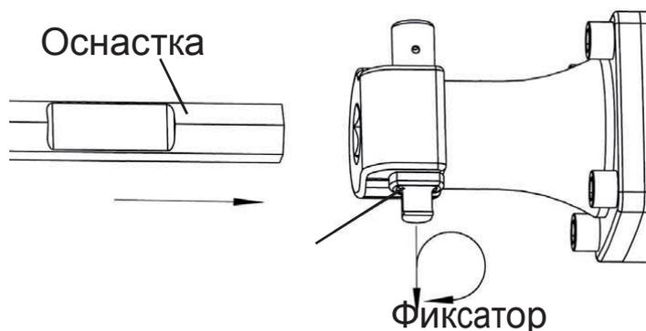
Для установки оснастки в патрон вытащите фиксатор и поверните его на 180° по часовой или против часовой стрелки. Вставьте хвостовик оснастки в ударный патрон, поверните фиксатор в исходное положение.
