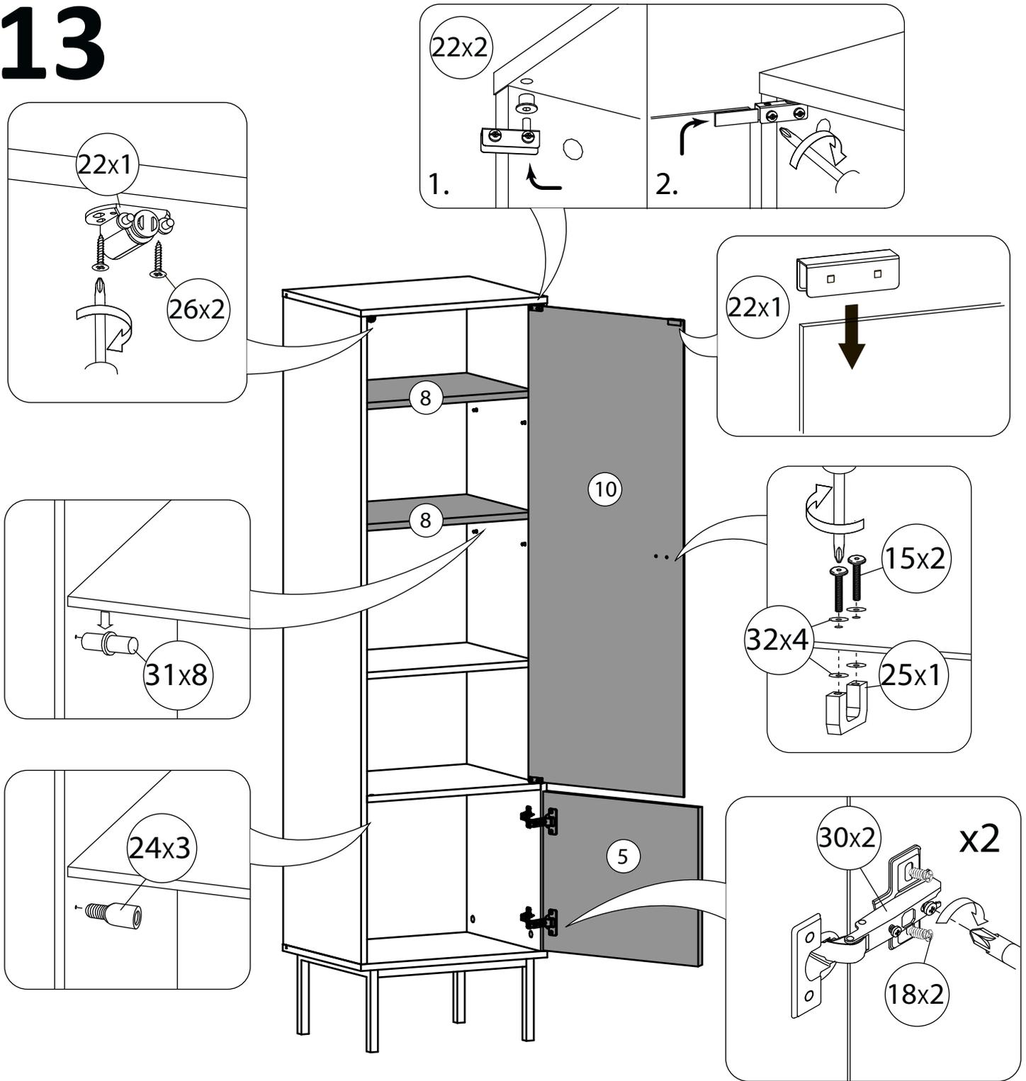
**!** Во избежании раскола стекла при закреплении ручек избегать чрезмерного затягивания винтов.
