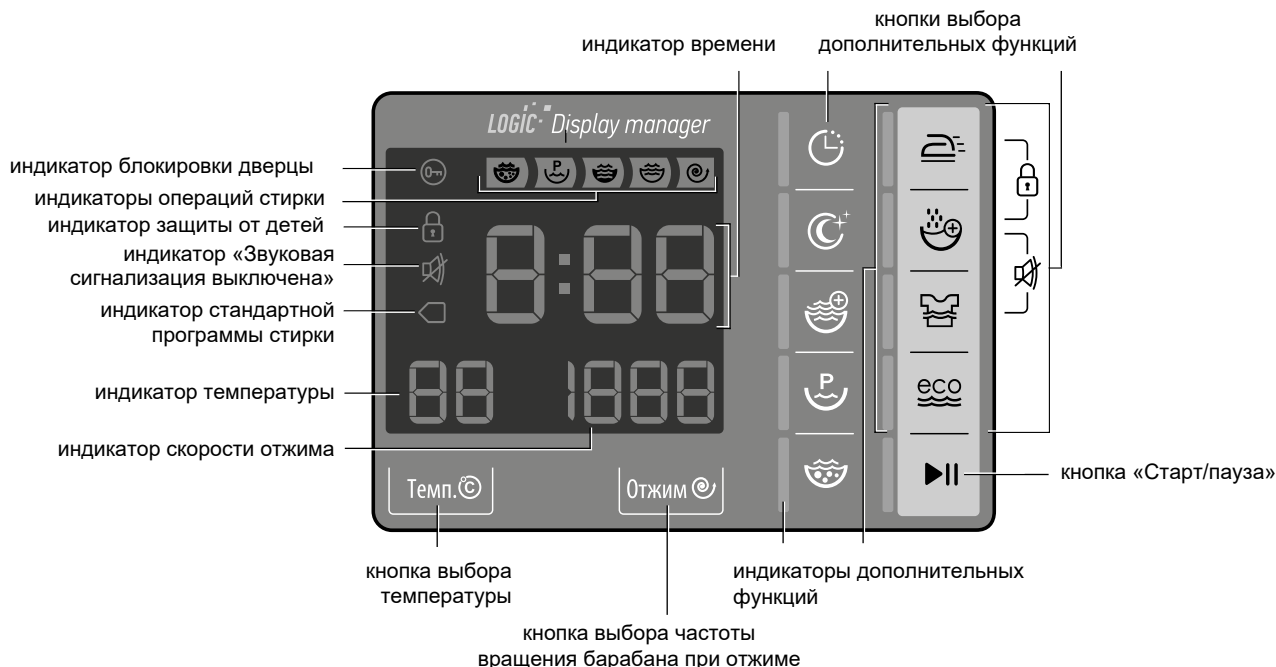
Рисунок 3 – Зоны индикации и кнопки управления
