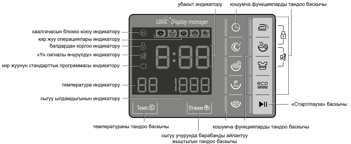
3-сүрөт – Индикация зонасы жана башкаруу баскычтары
