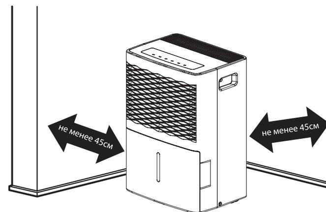
ПРИМЕЧАНИЕ: У осушителя имеются ролики для удобства установки, но перемещать его следует только по гладкой плоской поверхности. Не следует перемещать осушитель по ковру или над какими-либо предметами.
