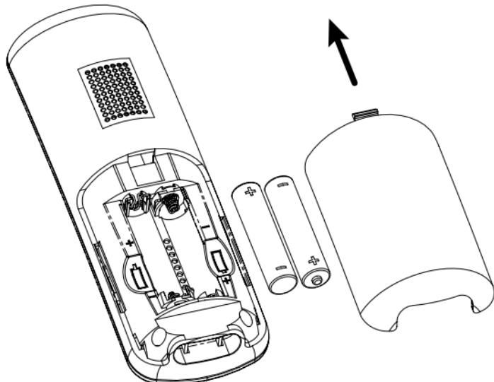
3) Закройте крышку отсека для аккумуляторных батарей.
