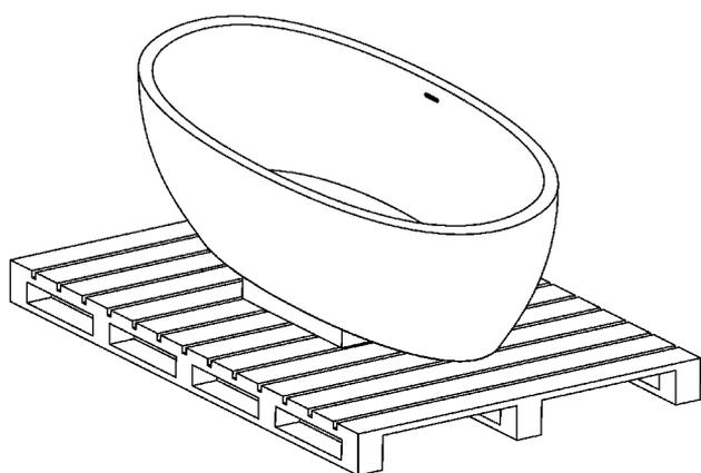
3. Транспортировку изделия к месту монтажа осуществлять на ремнях/монтажных стропах.
