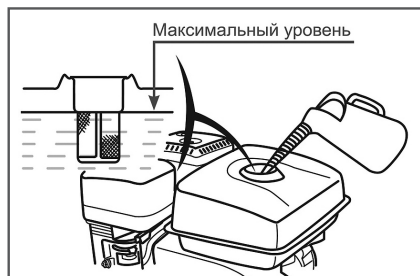
Рис. 11 Максимальный уровень топлива в топливном баке
