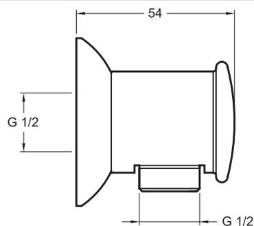
Спецификация продукта : Коленное соединение. E11627. Коллекция : ОБЩАЯ КАТЕГОРИЯ. ВЕС : 0.5 кг. МАТЕРИАЛ : N/A. ТИП УСТАНОВКИ : Крепление к стене. TYPE D'ACCESSOIRE : Коленное соединение. CLAPET ANTI-RETOUR : Oui.
