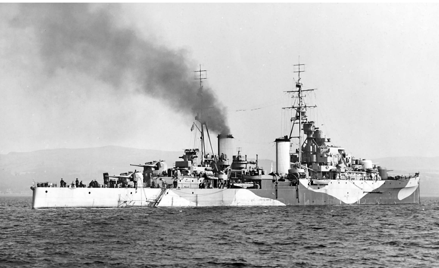
«Ряблист» в устье Клайда 9 сентября 1943 г. — вскоре после завершения ходовых испытаний и до начала переоборудования во флагманский корабль эскортных авианосцев. Крейсер еще сохраняет торпедные аппараты, которые будут демонтированы в ходе переоборудования
