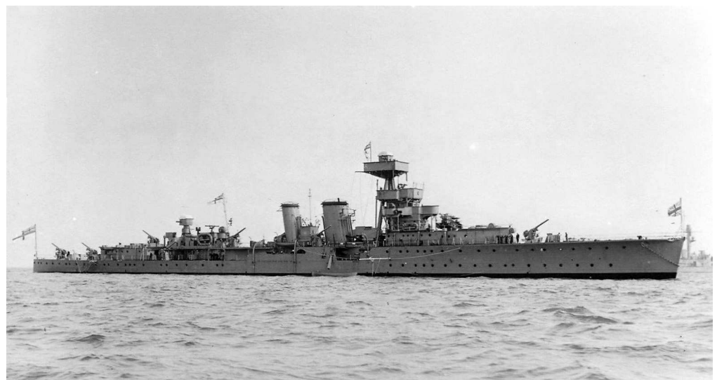
«Ковентри» после переоборудования в крейсер ПВО, май 1937 г. Два первых корабля данного класса несли по десять 102-мм зениток в одиночных установках, тогда как последующие крейсера ПВО оснащались спаренными
