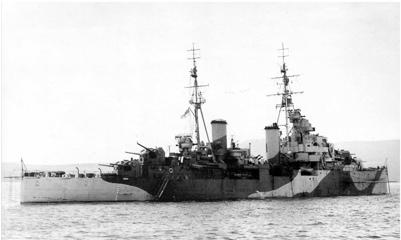
«Беллона» у Гринока накануне сдаточных испытаний, 12 октября 1943 г. Крейсер несет ставший к тому времени стандартным набор радиолокационных станций: типов 281, 282, 284, 285 и 272
