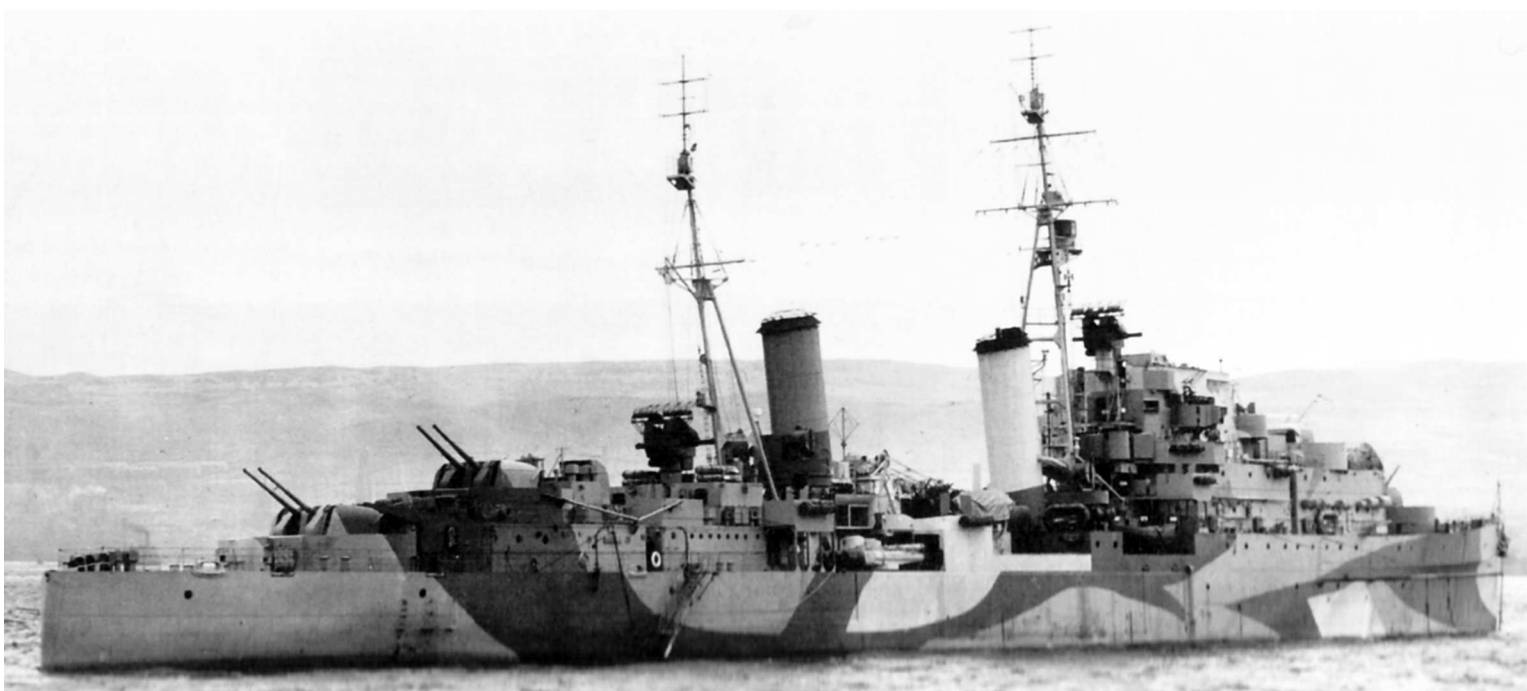
«Сцилла» в устье Клайда вскоре после ввода в состав флота, 25 июня 1942 г. Как и второй «беззубый дракон» — «Карибдис», — этот корабль вооружался четырьмя спаренными 114-мм орудиями в палубных установках со щитами и не имел командно-дальномерного поста главного калибра. Крейсер несет РЛС типов 281, 285, 282 и 272
