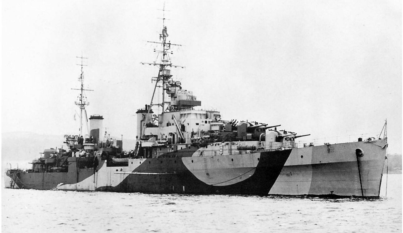
«Беллона» у Гринока накануне сдаточных испытаний, 12 октября 1943 г. Крейсер несет ставший к тому времени стандартным набор радиолокационных станций: типов 281, 282, 284, 285 и 272
