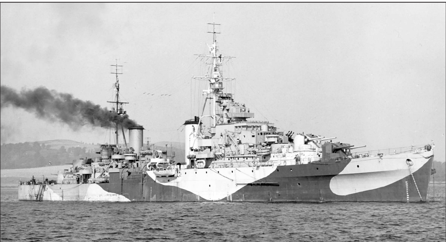
«Ряблист» в устье Клайда 9 сентября 1943 г. — вскоре после завершения ходовых испытаний и до начала переоборудования во флагманский корабль эскортных авианосцев. Крейсер еще сохраняет торпедные аппараты, которые будут демонтированы в ходе переоборудования
