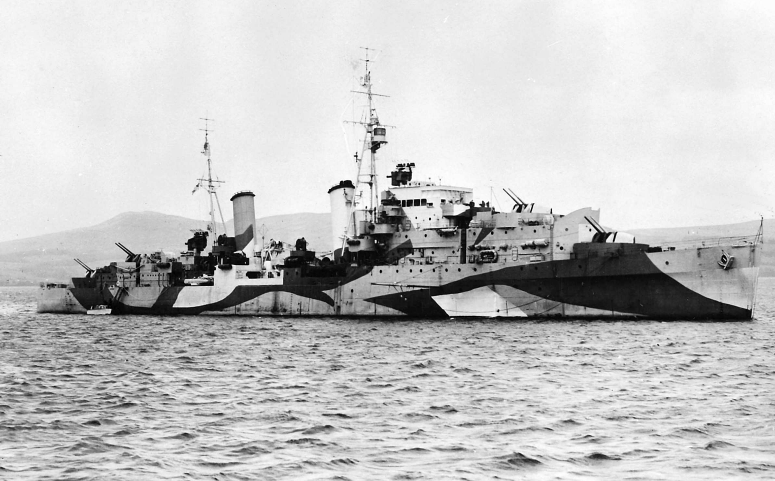
«Сцилла» в устье Клайда вскоре после ввода в состав флота, 25 июня 1942 г. Как и второй «беззубый дракон» — «Карибдис», — этот корабль вооружался четырьмя спаренными 114-мм орудиями в палубных установках со щитами и не имел командно-дальномерного поста главного калибра. Крейсер несет РЛС типов 281, 285, 282 и 272
