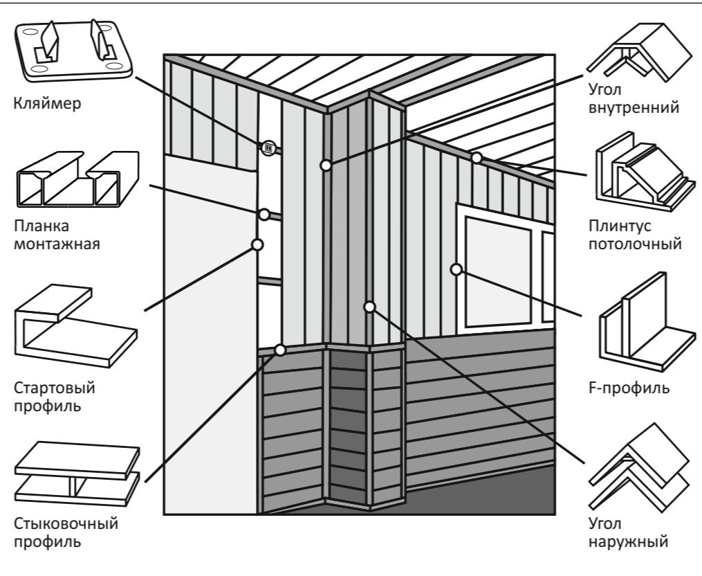
плинтус рекомендуем крепить к монтажной планке, которую следует закрепить под потолок.
