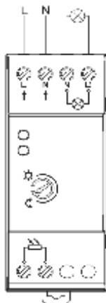
Рис. 3 Схема подключения фотореле DIN-1 (ФР)
