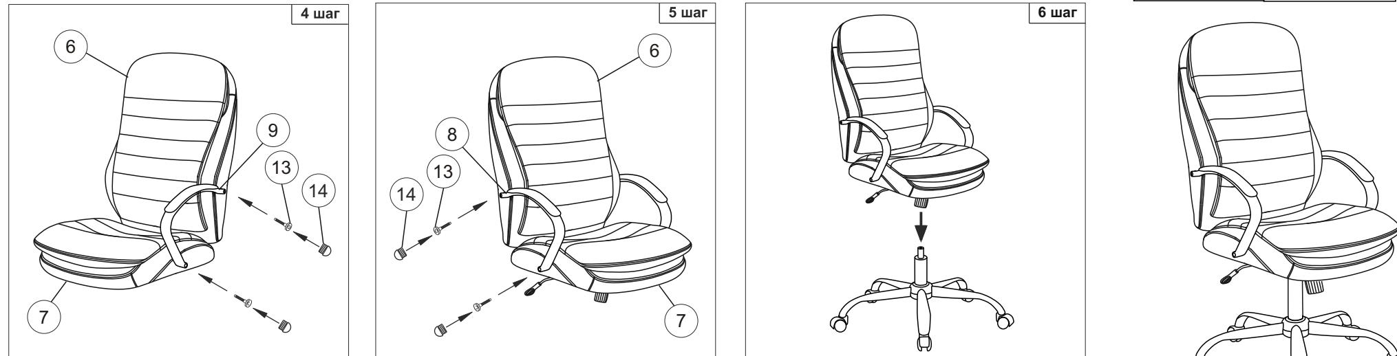
**Примечание:** Шаг 1. Снять защитный колпачок с газлифта, в случае его наличия. Шаг 4-5: Вставить и закрутить винты поочерёдно, не затягивая их до конца. После выполнения шага 5 закрутить все винты до полной фиксации.
