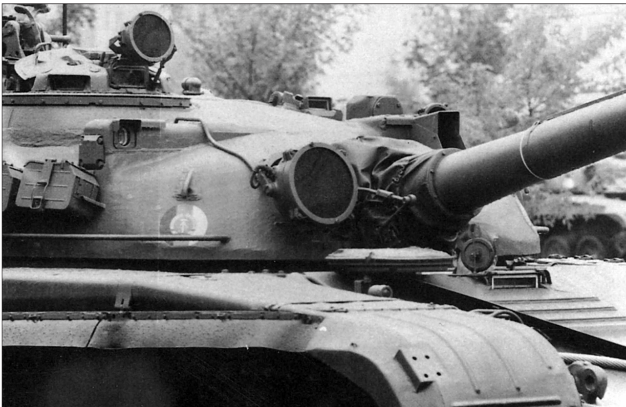
Башня танка Т-72 позднего выпуска. ИК-осветитель ночного прицела размещен на своем привычном месте — справа от пушки
