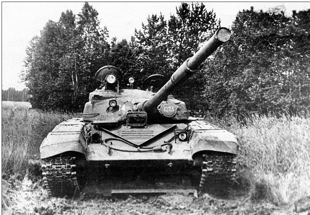
Танк «объект 172М» с оборудованием самоокапывания в рабочем положении
