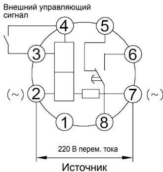
**Рис. 12: Схема проводных соединений JSZ3K (220 В)**
