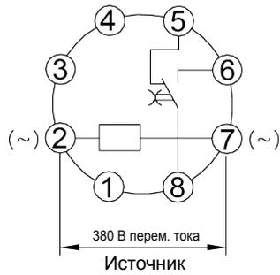
Рис. 23. Схема проводных соединений JSZ3R (380 В)
