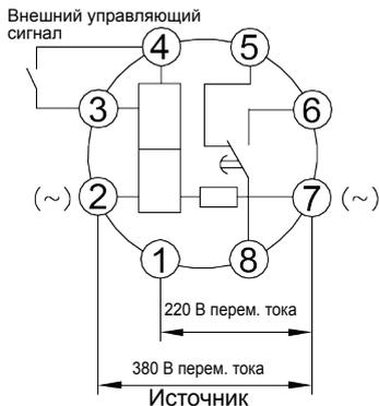
**Рис. 11: Схема проводных соединений JSZ3K (380 В, 220 В)**
