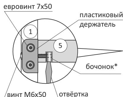
**36** Сборка механизма опускания
