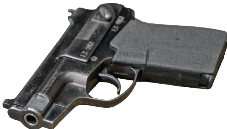
**УСМ (ударно-спусковой механизм):** двойного действия (выстрел можно произвести как предварительно взведя курок, так и обычным нажатием на спусковой крючок)
