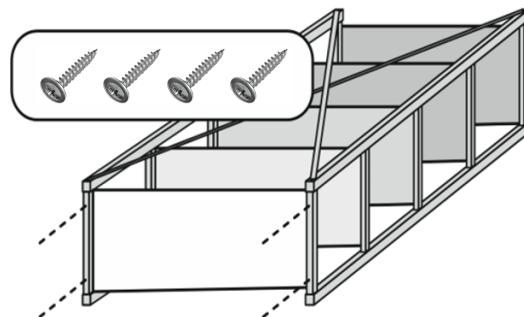
**Шаг 4:** Соедините болтами M6/15 стеллаж с **опорой стола** (подстольем) **усилителями жесткости** (соединителями): совместите отверстия на усилителях с отверстиями на опорах. Закрепите их болтами. Установите регулируемые ножки-опоры в посадочные места подстолья
