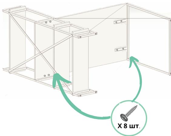
**Шаг 2:** Разместите каркас горизонтально. Поместите **полки** на направляющие (полка должна выступать с каждой стороны на 2 см от направляющей). Закрепите полки **саморезами** в местах соединения с каркасом.
