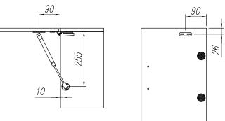
Схема монтажа крепежных планок газлифта на Боковину корпуса и Фасад. Более точная схема для определенного типа газлифта изображена на его упаковке.
