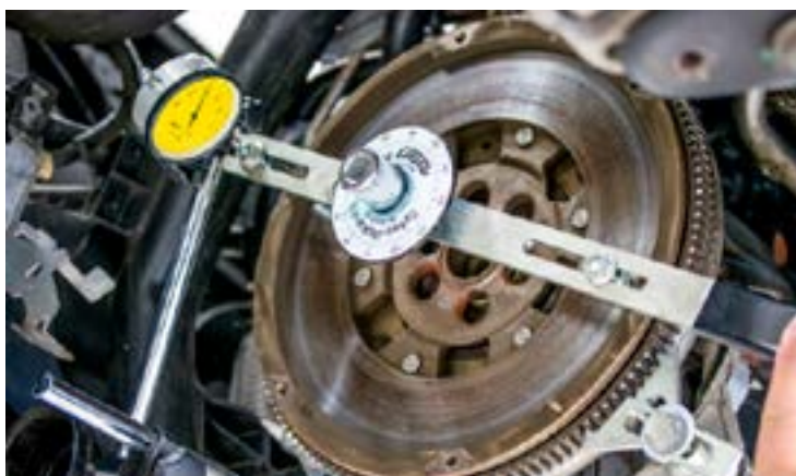
DMF специальный инструмент, номер для заказа: 400 0080 10
