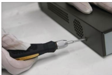
Ослабьте два верхних винта, чтобы снять крышку
