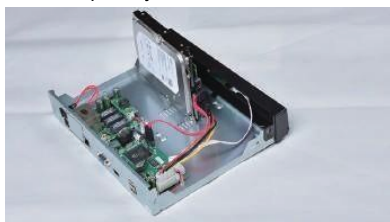
Подключите провода от ЖД к основной плате
