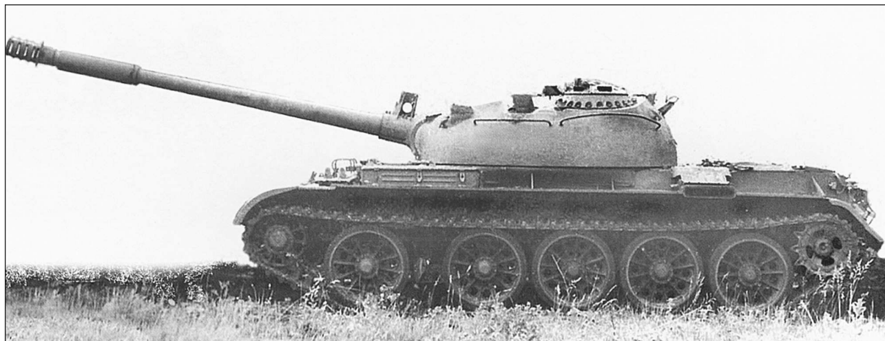
Опытный образец танка «объект 139» с пушкой Д-54ТС
