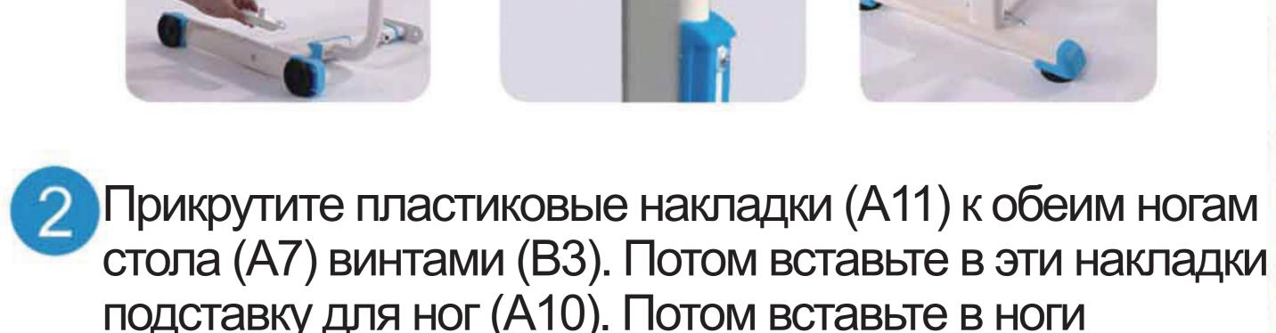
стола (A7) винтами (B3). Потом вставьте в эти накладки подставку для ног (А10). Потом вставьте в ноги шестигранный вал (А18). После этого прикрутите перемычку (А8) к другой ноге стола (А7) предустановленным винтом.
