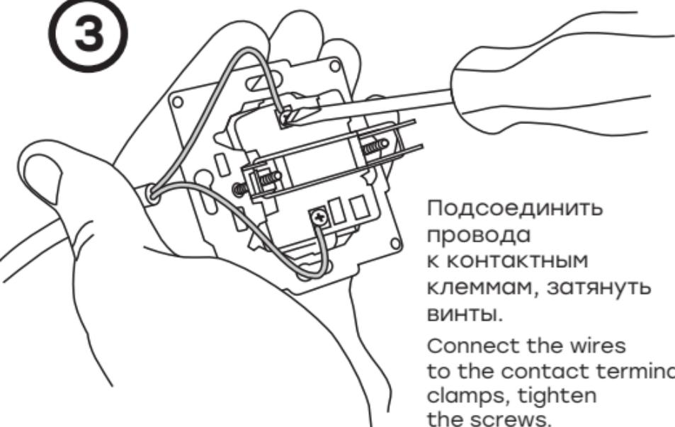
Подсоединить провода к контактным клеммам, затянуть винты.
