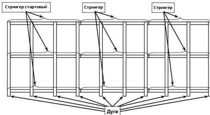
Первоначально устанавливаются крайние панели, затем средние, причем листы должны располагаться таким образом, чтобы изгиб был произведён исключительно вдоль линии каналов. Панели установите таким образом, чтобы они выходили за крайние дуги не менее чем на 5 см. Между собой по длине листы поликарбоната устанавливаются внахлест. Панели необходимо тщательно **выровнять** и закрепить саморезами в первую очередь по нижнему краю, затем по дугам, согласно просверленным отверстиям.
