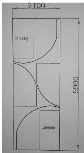
1 4.3.1. Разрежьте лист поликарбоната, как показано на схеме раскроя). Режется поликарбонат строительным ножом или электролобзиком.
