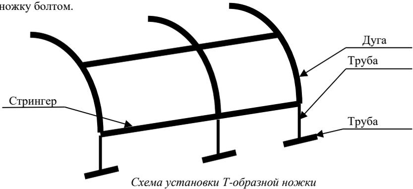
Схема установки Т-образной ножки
