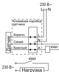
Рисунок 21 – Схема подключения датчика с контактором КМИ
