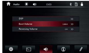
Настройки звука (DSP), уровня громкости при включении, уровня приглушения звука при включении задней передачи.
