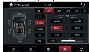
Выбор конфигурации акустических систем: 2-х, 3-х полосная или 5.1. Поканальная настройка фильтров низких и высоких частот: тип фильтра, значение частоты фильтра, значение крутизны среза фильтра, уровень громкости канала.
