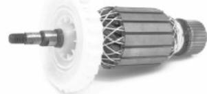
– внутренняя часть выполнена способом полностью автоматического накручивания нити, вокруг ротора добавлена сетка, препятствующая попаданию на эмалевые провода пыли, мелких камней и других инородных тел (эмалевый провод выполнен из медной проволоки, обладает устойчивостью к высоким температурам до 180°C), что увеличивает срок службы ротора. Содержание серебра в коммутаторе 8/10000, что делает поверхность коммутатора более гладкой, увеличивая срок эксплуатации.
