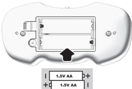
3. Установите крышку аккумуляторного отсека на место и зафиксируйте её винтом по часовой стрелке с помощью отвёртки.
