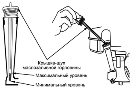
Рис. 7 Проверка уровня масла в картере
