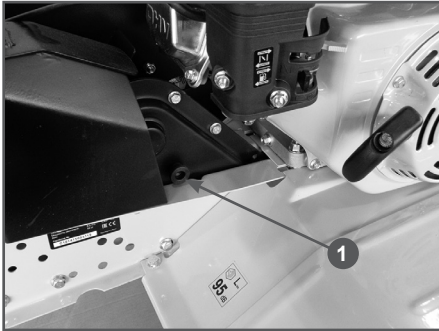
Рис. 25 Расположение пробки отверстия для добавления смазки в редуктор
