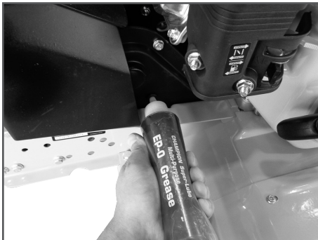
Рис. 26 Добавление смазки в редуктор
