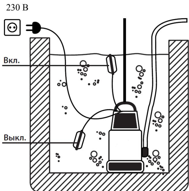
Необходимо удостовериться, что при минимальном уровне воды выключатель отключает насос. Убедитесь, что объем воды в пределах «Вкл.» и «Выкл.» поля регулирования по отношению к количеству перекачиваемой воды и не требует от насоса более 20 включений в час.
