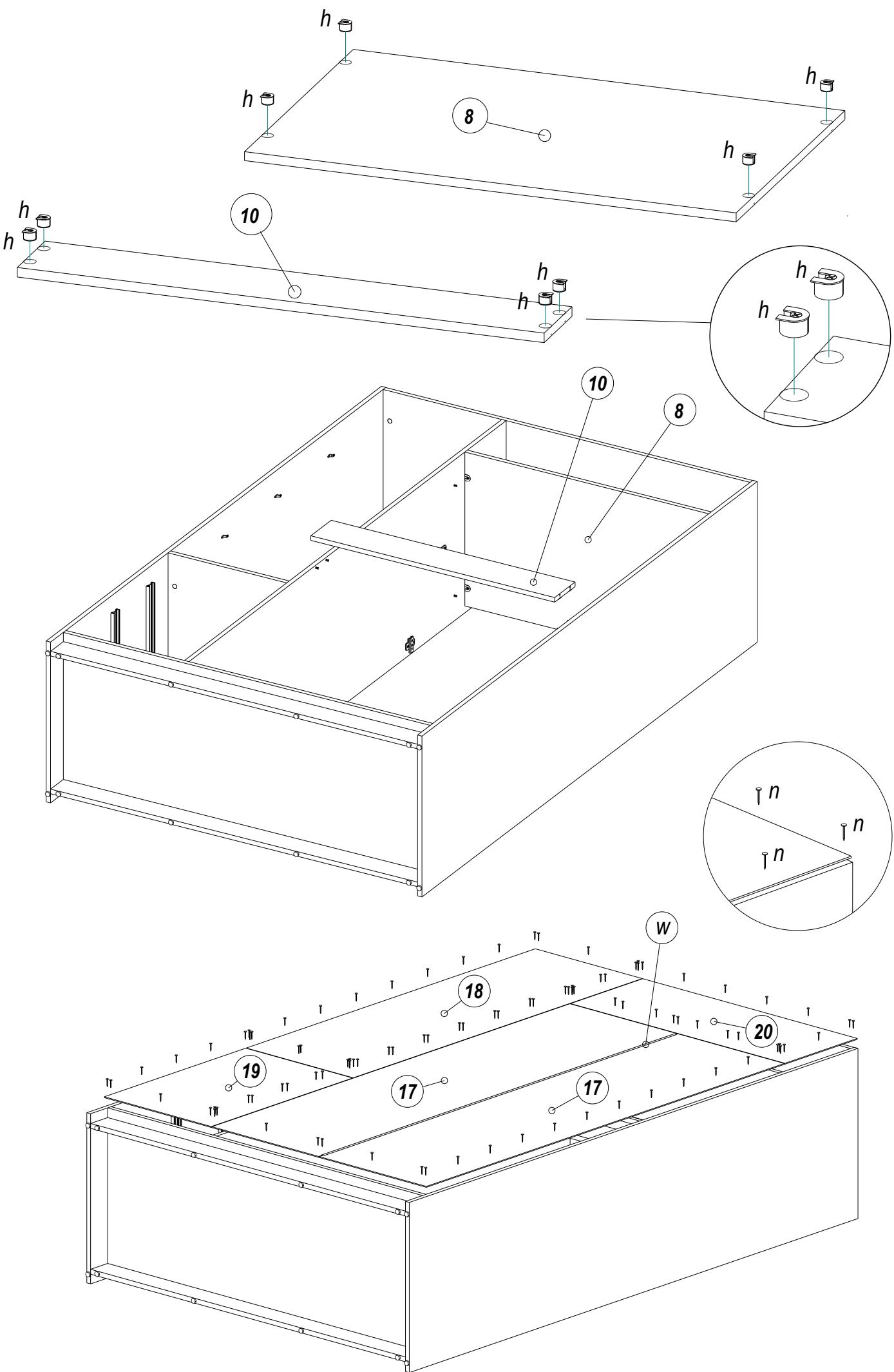
Шариковую направляющую (поз.и) крепить только после сборки ящика!
