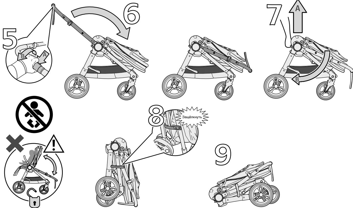
Складывание шасси – без прогулочного блока
