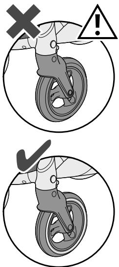
Раскладывание шасси— без прогулочного блока
