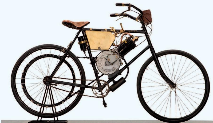
Наибольшую известность фирме Де Дион-Бутон принесли их новаторские автомобили и трехколесные велосипеды, но они также производили и моторы для мотоциклов, которые считаются первыми высокоскоростными двигателями внутреннего сгорания облегченного типа. Многие производители копировали дизайн и конструкцию этих двигателей, среди них и Harley-Davidson.
