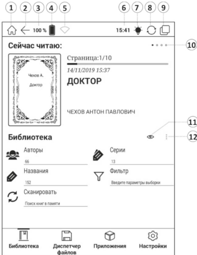
1. На главную страницу / 2. На шаг назад / 3. Заряд аккумулятора / 4. Индикатор заряда / 5. Индикатор сетевого подключения / 6. Время / 7. Управление подсветкой / 8. Переключатель режимов работы экрана / 9. Активные приложения / 10. Индикатор номера книги / 11. Внешний вид / 12. Тип информации
