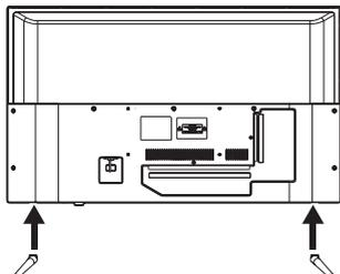
3. Закрепите стойки при помощи винтов (входящих в комплектацию прибора).
