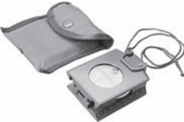
Жидкостный магнитный компас с уклонометром, фосфоресцирующей шкалой, визиром и прицельной нитью в металлическом корпусе. Компас DC60-1А брызгозащищен и предназначен для ориентирования на суше и на воде. По конструкции компас — жидкостный (раствор по составу близок к керосину), отличительной особенностью таких компасов является скорость
