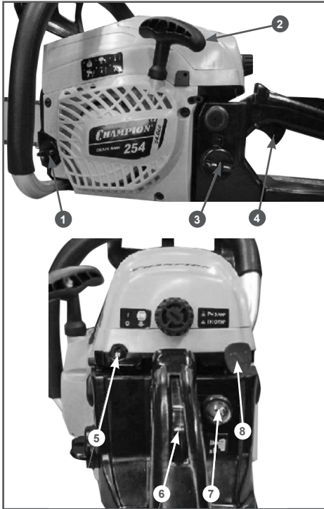
Рис. 11 Органы управления, необходимые для запуска бензопилы
