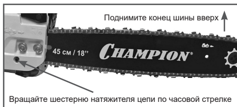
Рис. 5 Регулировка натяжения цепи
