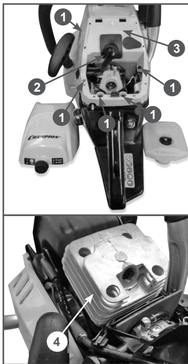
Рис. 23 Очистка охлаждающих ребер цилиндра
