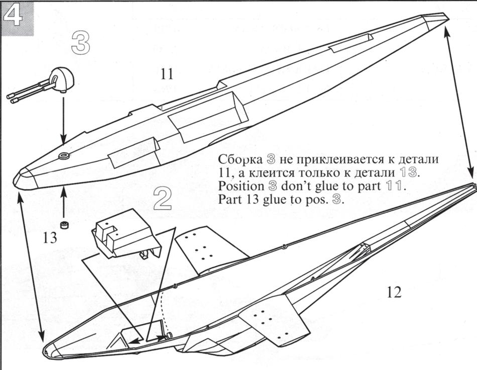
Сборка 3 не приклеивается к детали 11, а клеится только к детали 13.
