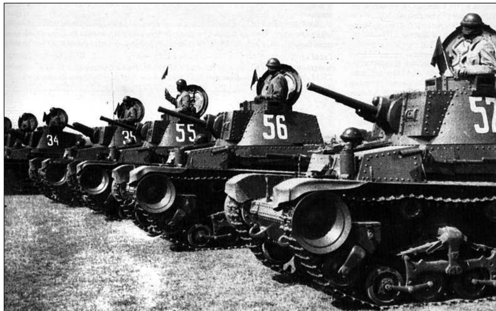
Легкие танки Skoda Т-11 и LT vz.35 из состава 3-й роты средних танков болгарской армии. 1941 год
