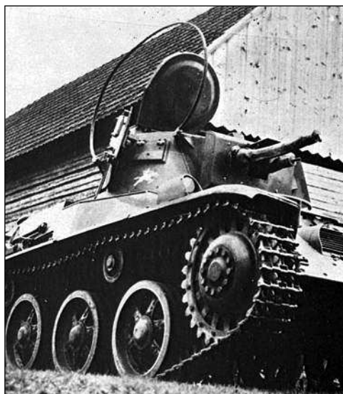
Легкий танк Toldi I с установленной радиостанцией. Ее подковообразная антенна хорошо видна на правом борту башни
