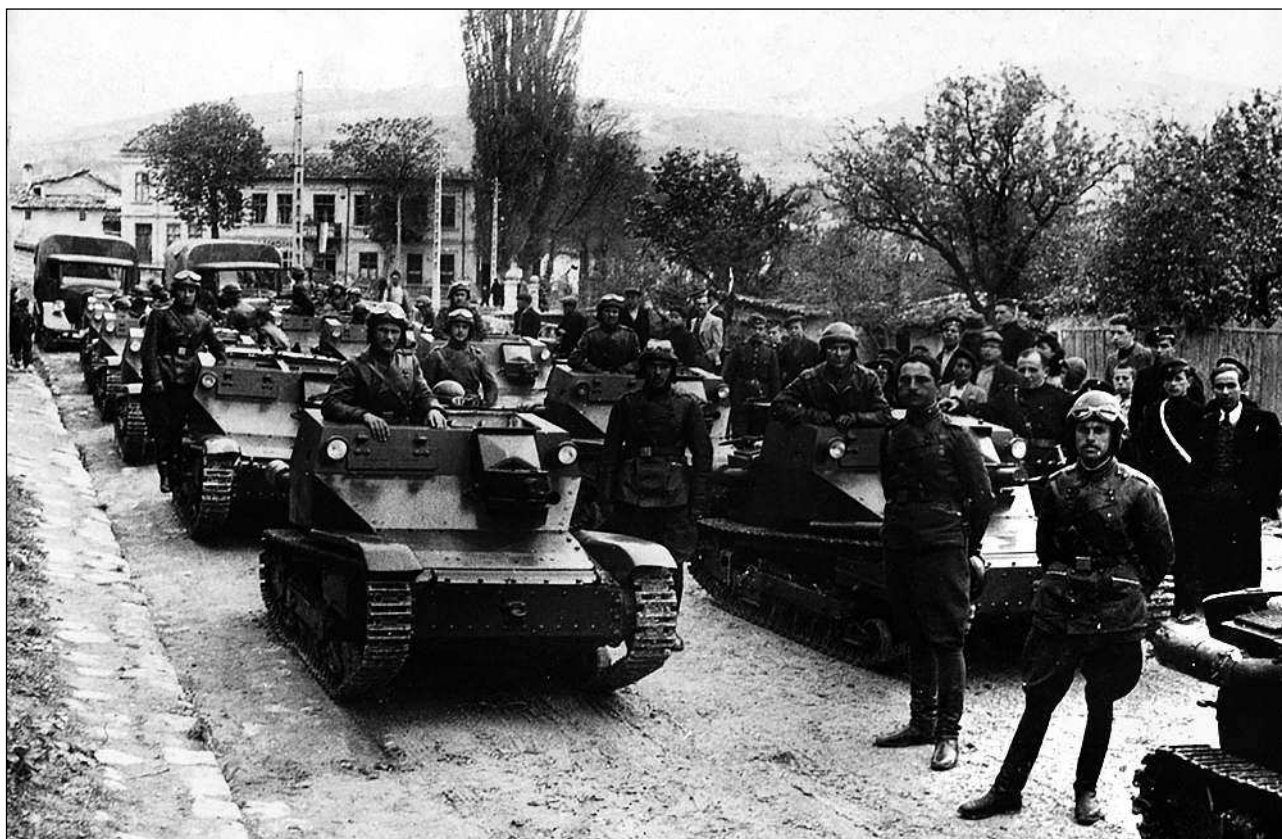
1-я танковая рота болгарской армии в походной колонне. 1937 год. Хорошо видны пулеметы MG 08/15, установленные вместо штатных пулеметов FIAT
