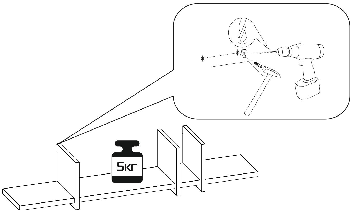
**Для избежания повреждения газовых, вентиляционных, водопроводных и электрических коммуникаций, обратите внимание на их расположение!**
