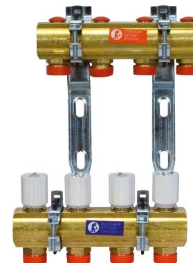
**IT** - Collettore premontato correddato sull'andata da detentori incorporati a doppia regolazione, sul ritorno da valvole termostatiche e dalle zanche. Gli adattatori R178 o R179 devono avere diametro base da 18.
