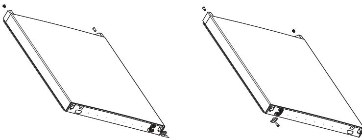
7. Установите дверь морозильной камеры на нижнюю петлю, затем установите среднюю петлю, тем самым зафиксировав дверь морозильной камеры.
