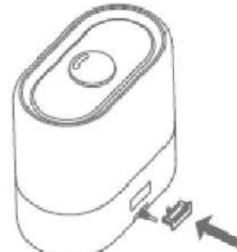
3. Закройте крышку и вставьте вилку шнура питания в розетку. Услышав звуковой сигнал, поверните ручку по часовой стрелке, чтобы включить увлажнитель (подробные сведения см. в разделе «Описание функций»).
