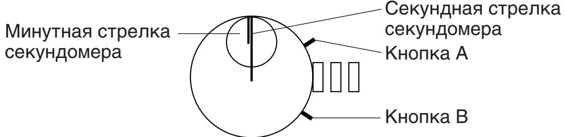
Впоследствии, если Вы продолжаете нажимать Кнопку А в течение приблизительно 2 секунд, секундная стрелка секундомера сделает один круг.
