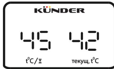
Слева отображается температура нагрева воды, справа – текущая температура
