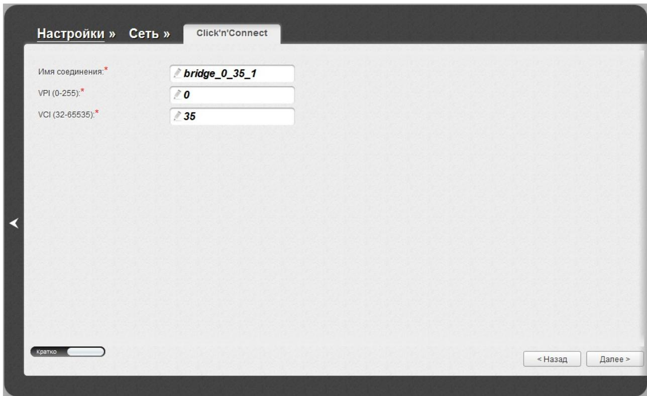
Рисунок 42. Настройка WAN-соединения типа Bridge.
