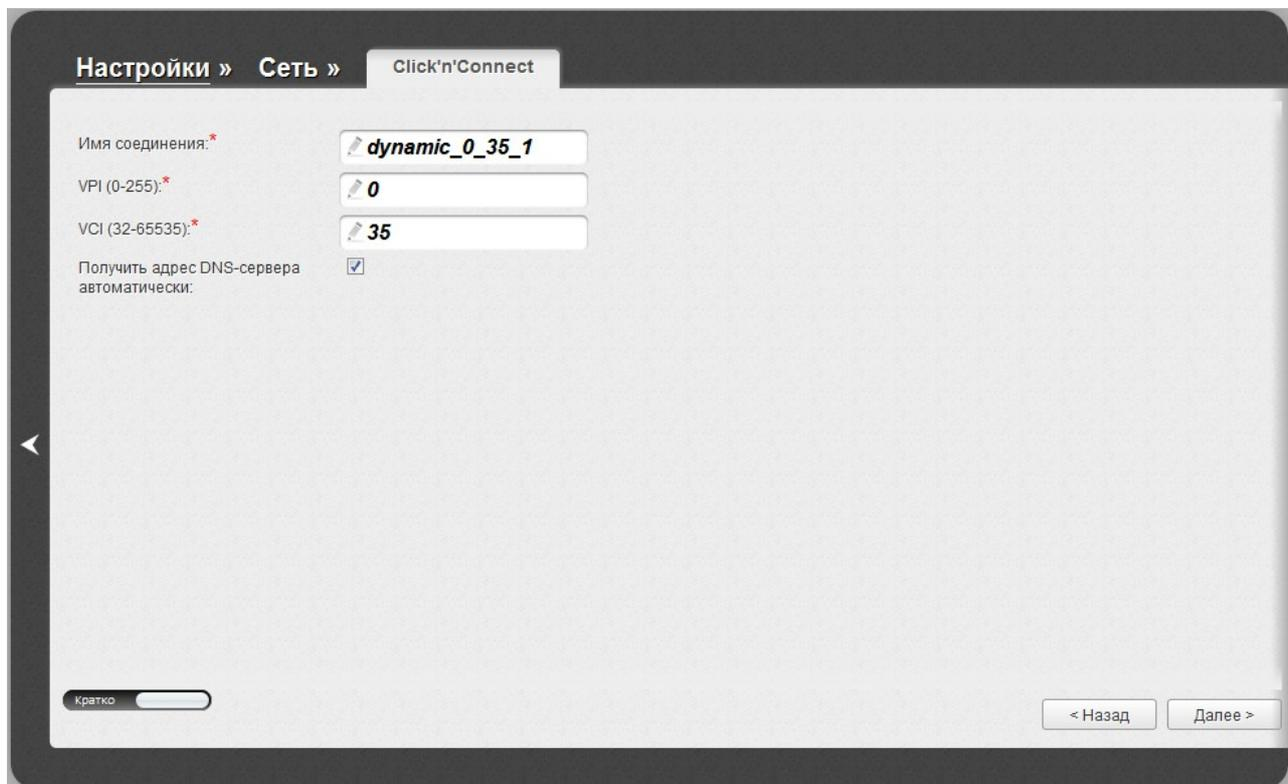
Рисунок 38. Настройка WAN-соединения типа Динамический IP.
