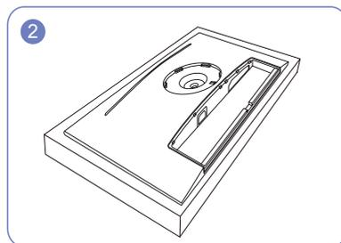
Положите на пол защитный пенопластовый материал (стирофом), входящий в комплект, и разместите на нем устройство экраном книзу, как показано на рисунке.
