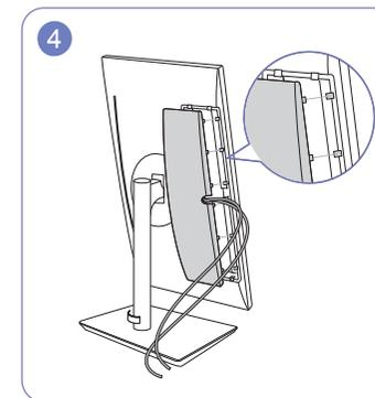
Уложите кабели через паз на ЗАДНЕЙ ПАНЕЛИ, а затем прикрепите КРЫШКУ ЗАДНЕЙ ПАНЕЛИ. При установке КРЫШКИ ЗАДНЕЙ ПАНЕЛИ, в первую очередь направьте шесть ребер КРЫШКИ ЗАДНЕЙ ПАНЕЛИ к нижним отверстиям ЗАДНЕЙ ПАНЕЛИ.
