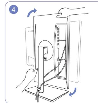
Поверните устройство в горизонтальное положение.
