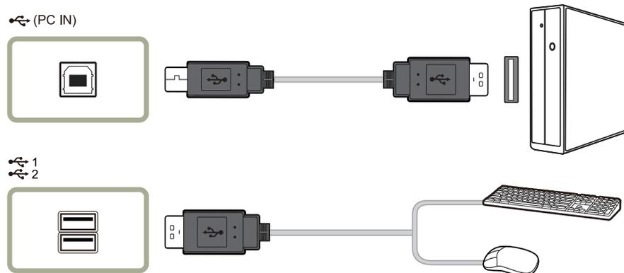
1 С помощью кабеля USB выполните подключение порта
