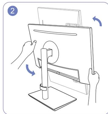
Поверните устройство в самое высокое вертикальное положение.
