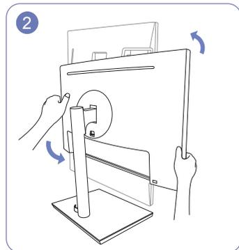
Поверните устройство в самое высокое вертикальное положение.
